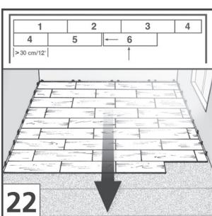
uporabo izolacijske podlage. Izolacijska podloga se polaga na »stik«, torej brez prekrivanja [8]. Paziti je treba, da stiki izolacijske podlage ne bodo tik pod fugami laminata. Če imajo laminatna tla že vdelano izolacijsko podlogo, dodatna ni potrebna [9].
